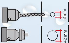
1. Percer un pré-trou de 8mm (foret non fourni) qui servira de guide à la scie-cloche et faire le trou de 44mm.
