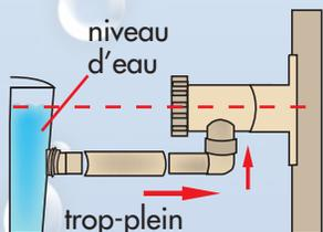
5. Placer le coude sur le robinet. Fixer l'embout à la cuve. Relier l'embout au coude avec le tuyau.
