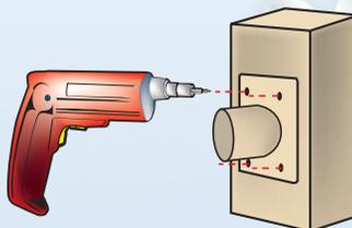
3. Fixer la bride au moyen des 4 vis autoforeuses. L'épaulement de la bride venant s'insérer dans le diamètre 44 mm avec l'encoche vers le bas.
